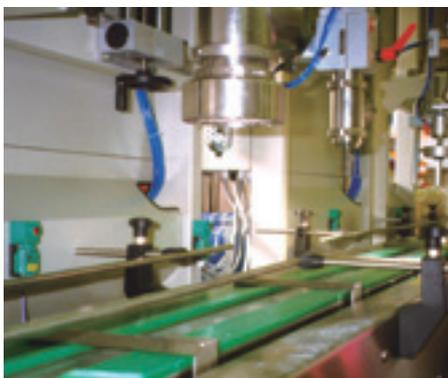
在Krones的灌装生产线，AS-Interface总线用在几个车间用于工厂的生产过程控制，如空瓶分拣，清洗，灌装和贴标签。根据客户的要求，Krones与倍加福合作将总线的概念引入到整个工厂。由于AS-Interface总线灵活的理念，客户可以在任何时间方便地扩展和更改设备。
