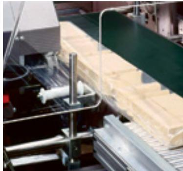
■ 输送带使用编码器监测速度和物体在输送带上移动距离
