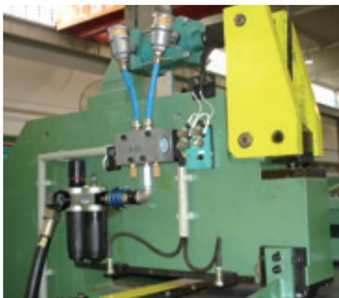
变压器铁心片数控横剪生产线上每个机器设备段的传感器、执行器信号都需送入PLC控制柜,传统的方法是传感器、执行器单独供电,信号再传送到PLC控制柜,拖曳众多柔性电缆,使得机器设备段与控制柜间的连接非常麻烦,也给维护造成许多不便。
